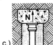
29. ábra: Kitámasztó betontömbök elrendezése:
