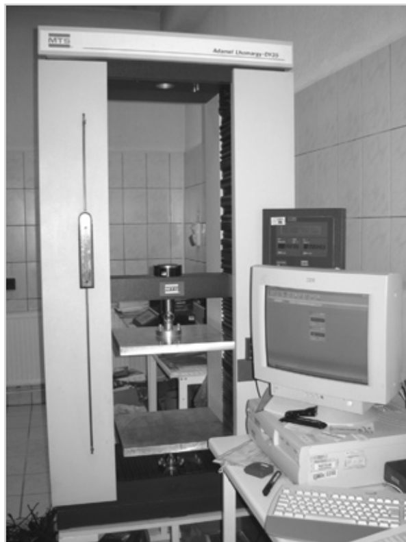
9. ábra: Húzó- és nyomóvizsgálatok elvégzésére alkalmas berendezés, számítógépes vezérléssel és adatrögzítéssel
