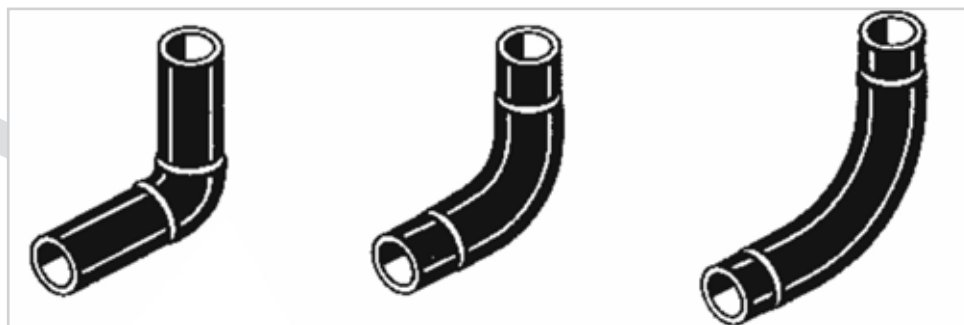
30. ábra: Korszerű fröccsöntött ívidomok a feszültséggyűjtő helyek megerősítésével
